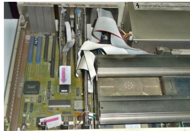
Mainboard EC 1835 mit CMOS gate array U5301 [ZMD/E2]
